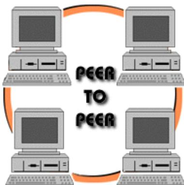
Un réseau p2p est un réseau où les postes de travail sont liés ensemble à l'aide d'un routeur ou d'un commutateur. Ce réseau n'a aucun serveur central. Ce type de réseau est largement utilisé dans les petits environnements de réseau. Ce type de réseau est relativement facile à mettre en place.
